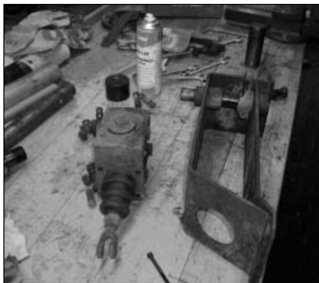
1. Hovedbremsecylinder taget ud af monteringsramme.
