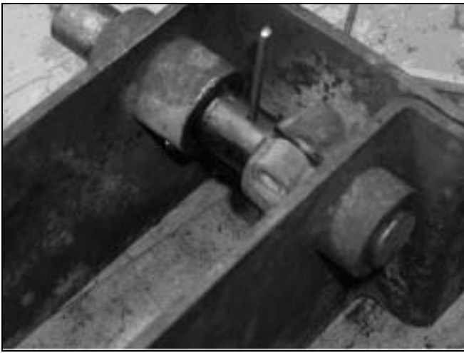
4. Dorn isat, klar til uddrivning af den famøse vuggekile.
