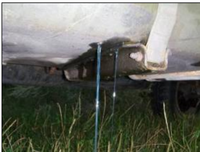
Fig. 5 - Gennemtæring af tankbund.
