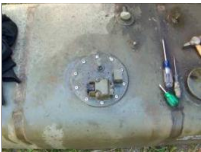
Fig. 1 - Pumpens placering i brændstoftanken.
