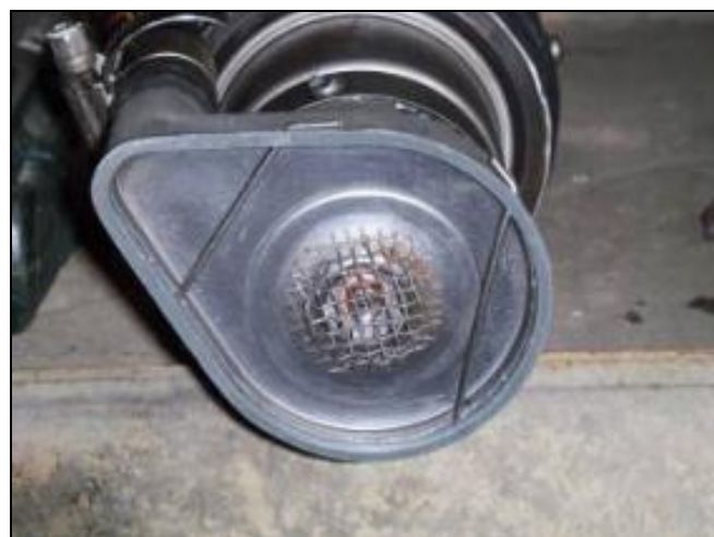
Fig. 4 - Pumpens endedæksel sikret med tværstiften.
