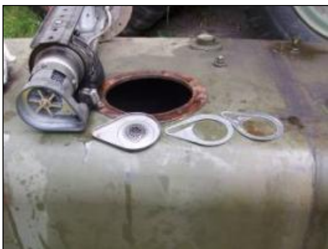
Fig. 2 - Pumpen og de dele som lå i tanken.
