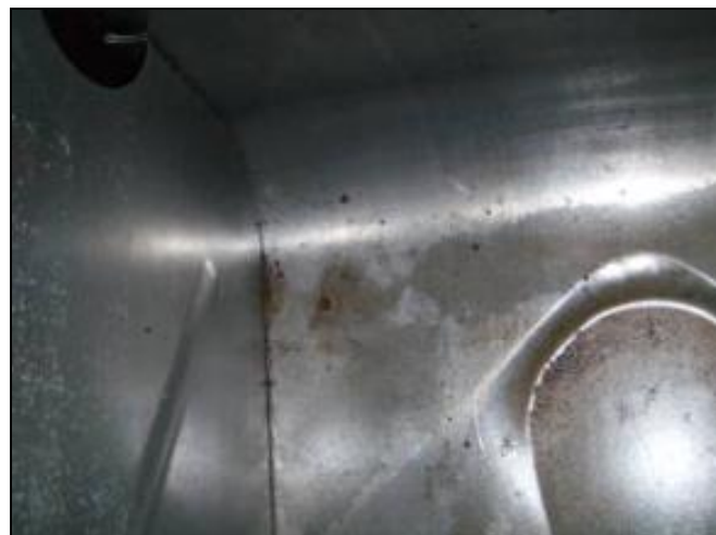
Fig. 6 - Tankbund indvendigt. Mørke pletter er rust.
