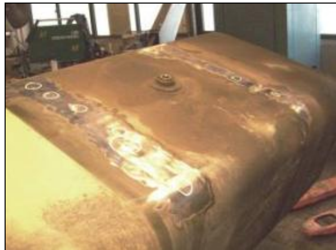
Fig. 7 - Tankbund udvendigt, cirkler angiver huller.
