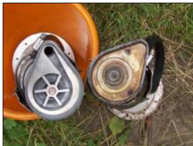
Fig. 3 - De 2 pumper, bemærk den til højre har 2 stifter.
