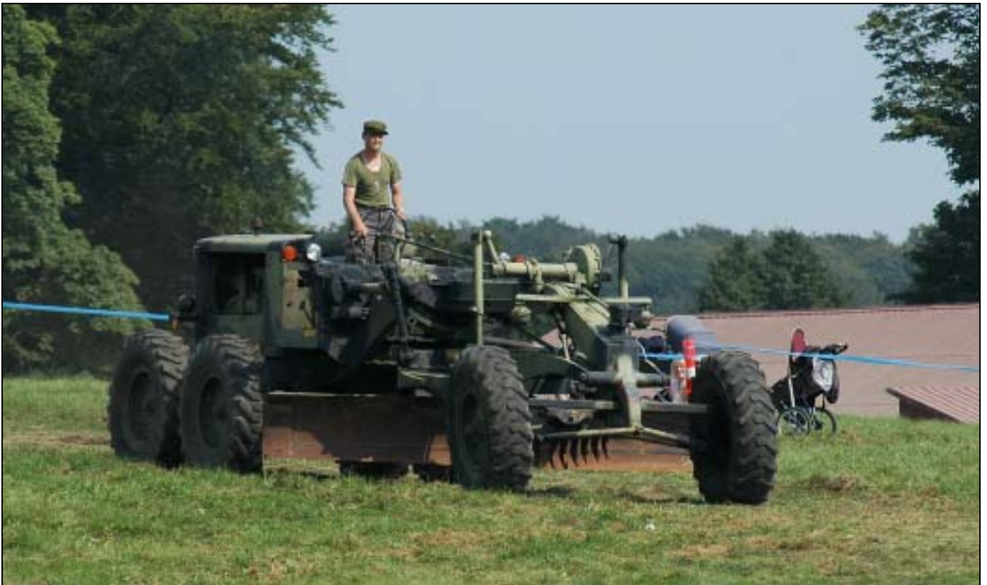
En højt usædvanlig maskine. En Caterpillar D12 "Grader" eller Vejhøvl. Disse maskiner blev brugt under og efter 2. verdenskrig til at bygge veje og landingsbaner. Erling gav os og publikum en fin demonstration af hvad den kan, og fik samtidig rettet lidt op på det roderi som bæltekøretøjerne havde lavet. (Frank Hestehaug)
